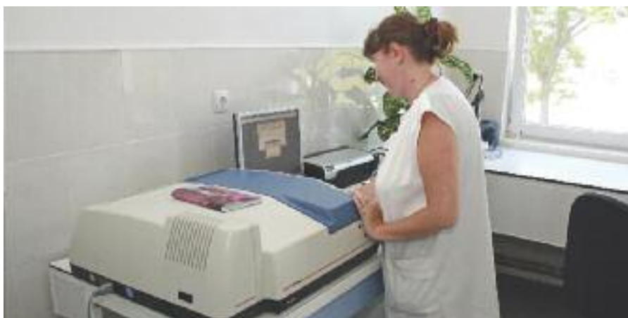
Stația de la Mărtinești: spectrofotometru, unul dintre echipamentele cu care a fost dotat laboratorul stației
